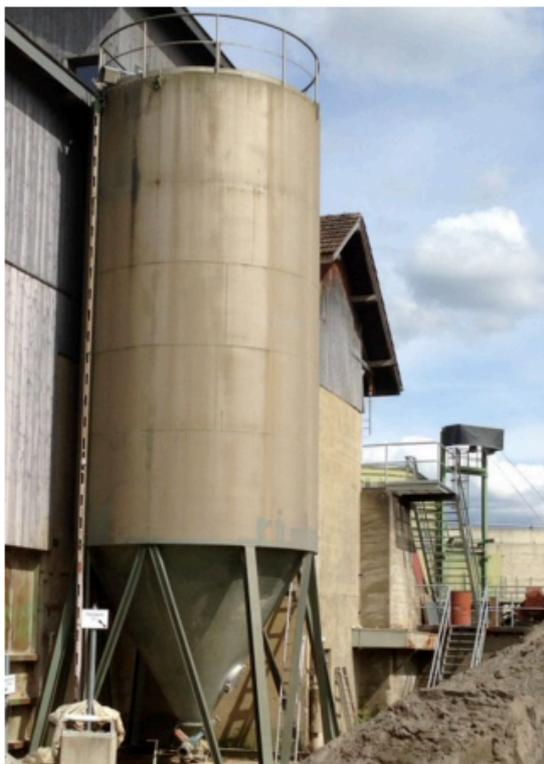
Tank zum Zwischenlagern des Schlammes
